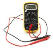
Fig. 1.4.11: Digital multimeter
